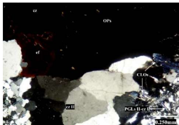
Figura 4b. Fotomicrografía con minerales opacos (OPs) intercrecidos con esfalerita (ef), de reflexiones internas rojizas, cloritas (CLOs) y agregados granulares de cuarzo II (cz II) relleno de plagioclasas II (PGLs II) y cuarzo I (cz I).
